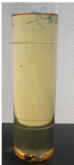
Figura 28 - Tubo de Ball Fall após a realização do ensaio de viscosidade
