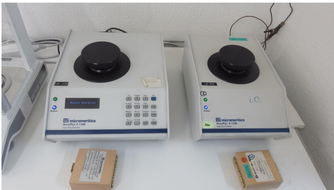
Figura 31 - Picnómetro de marca Micromeritics e modelo AccuPyc II 1340
