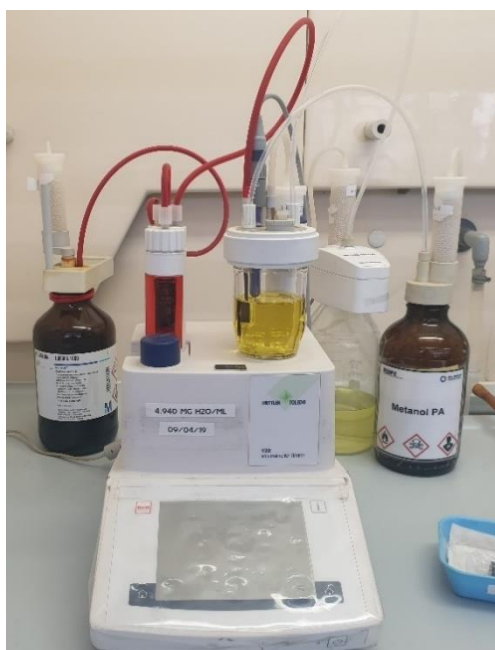
Figura 26 – Titulador volumétrico Karl-Fischer Mettler Toledo V10S
