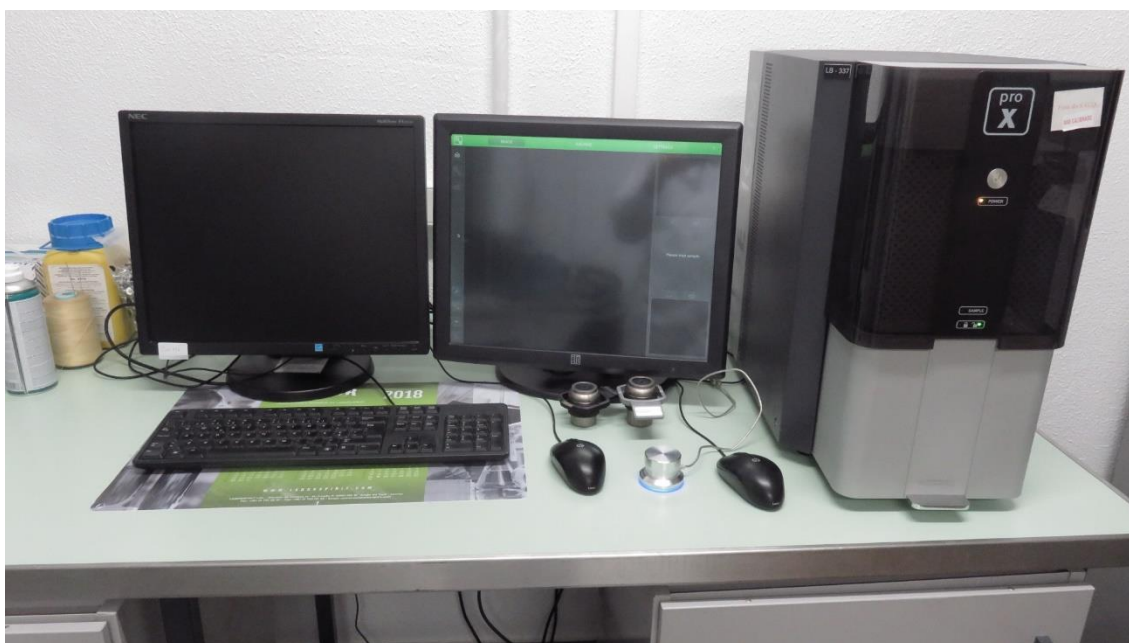
Figura 29 - Microscópio eletrónico de varrimento da marca Phenom ProX
