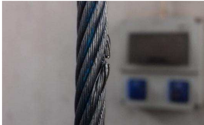
Figura 49 – Arames exteriores do 1º provete para fragilização do mesmo
