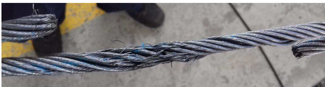
Figura 51 – Arames do 2º provete cortados com o alicate
