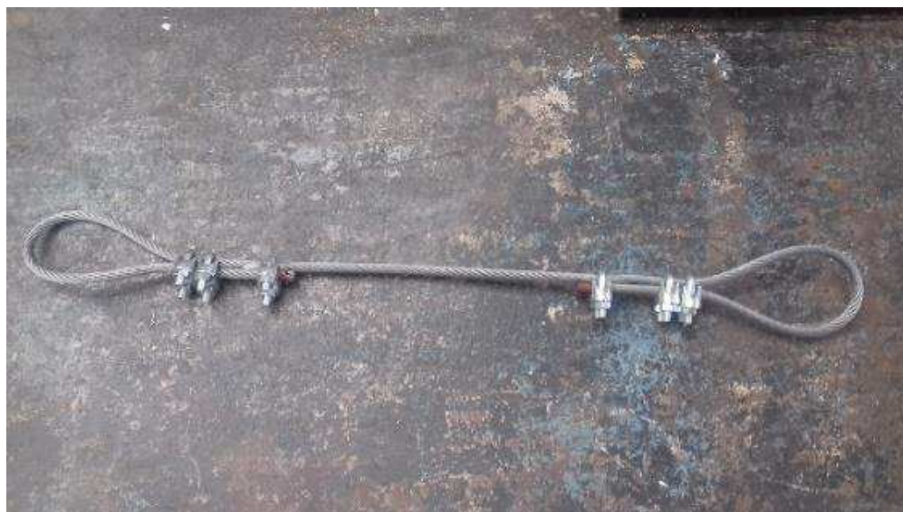
Figura 40 – 1º Provede utilizado no 1º ao 7º teste efectuado com a máquina de tração
