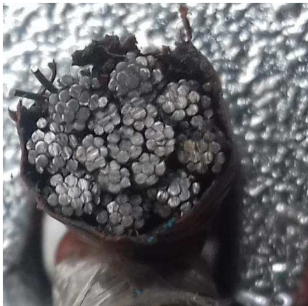
Figura 36 – Secção do cabo e representação desta (ISO 4309:2010)
