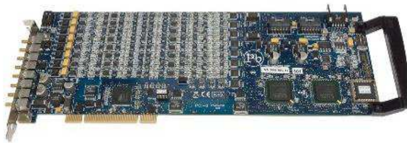
Figura 37 - Placa de captação de sinais PCI-8 (MISTRAS Group, 2009)
