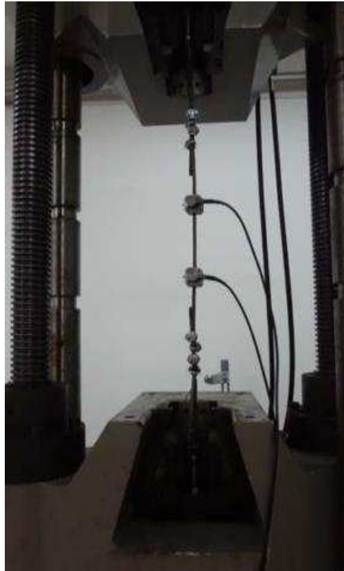
Figura 35 –Ensaio de tração dos cabos (Wenjie et al., 2013)
