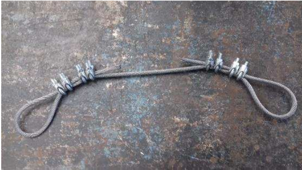
Figura 42 – 2º Provete utilizado no 8º teste efectuado com a máquina de tracção
