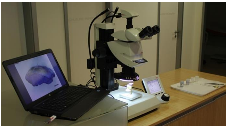
Abbildung 5: RLE Arbeitsplatz in der Praxisklinik Tübingen – Haut und Venen mit dem Leica- Stereomikroskop MA205A und einem selbstentwickelten Halteapparat.
