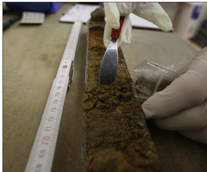
6. kép. Egy földminta belső rétegsora. A félbevágott furat készen áll a dokumentációra és az egyes rétegekből való mintavételre (fénykép: J. Kalmbach)
