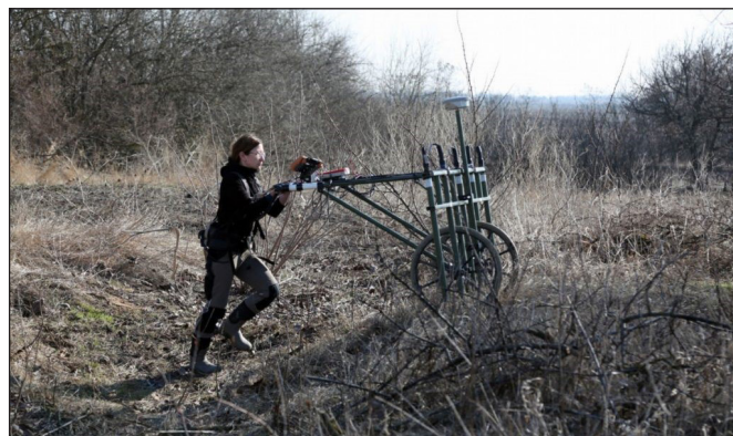
5. kép. Munkában az 5 szondás eszköz a Hódmezővásárhelyi tell-település közelében (fénykép: R. Scholz)
