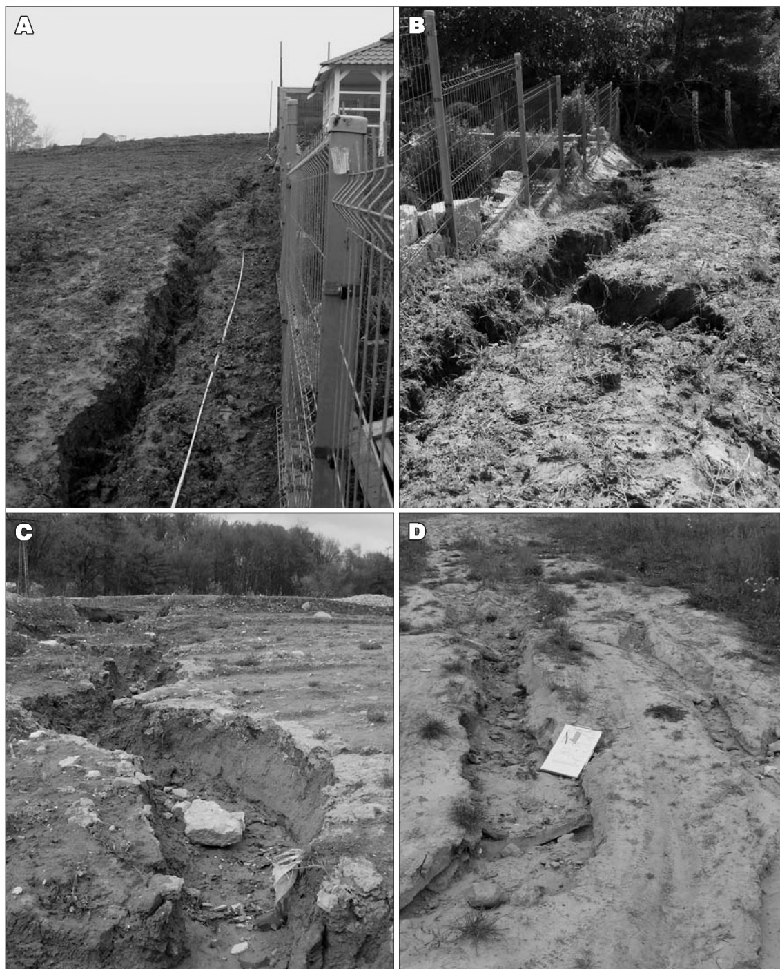
Ryc. 3A–D. Bruzdy erozyjne – skutki wystąpienia splywu powierzchniowego w formie skoncentrowanej. Wszystkie prezentowane bruzdy są świeże, powstałe w ciągu kilku miesięcy, a w praktyce w czasie jednego lub dwóch opadów nawalnych. Wielkość bruzd zależy od podłoża, nachylenia terenu i wielkości przepływu. Fot. B. Rzonca
