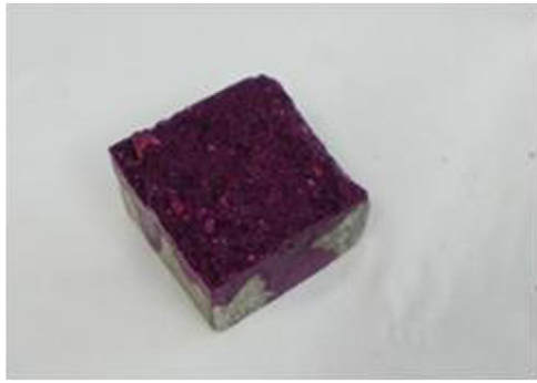
Figura 8 – Ensayo del test de fenolftaleína.
