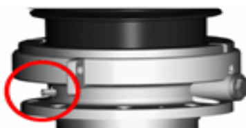
Figura 1.21 Válvula de toma de muestras de aceite [ (BUSHINGS)
