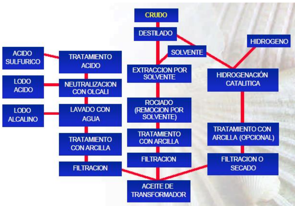
Figura 2.2 Diagrama de fabricación de un aceite dieléctrico [ (Brettis, 2018)]
