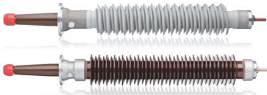
Figura 1.13 Bornas aceite/aire con cuerpo aislante de silicón y porcelana para rangos de tensión entre 24 y 550 kV y corriente hasta 5000 A [ (BUSHINGS)]
