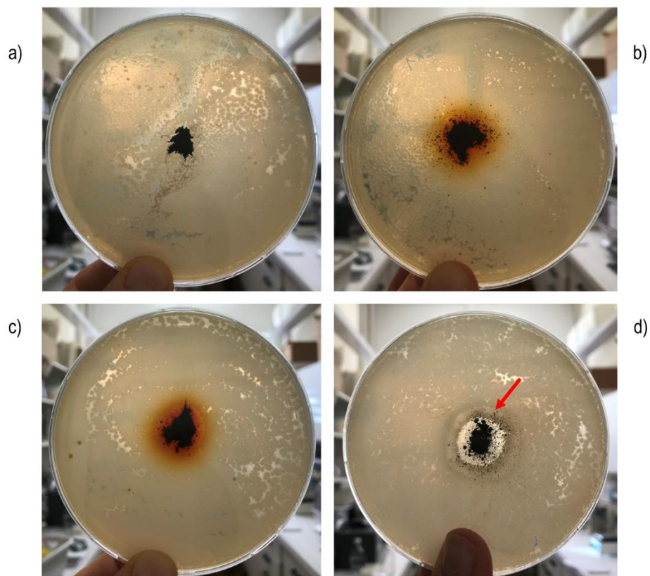
Slika 2-31: Neprevlečeni MNPs (a), CMD1-MNPs (b), CMD2-MNPs (c) in CMD3-MNPs (d) na bakterijski kulturi E. coli po inkubaciji. Inhibicijska cona prikazana na vzorcu CMD3-MNPs (d)
