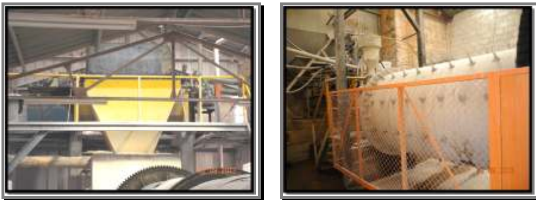
Figura 5. Planta de tritución de la fluorita llevada a un tamaño menor de 12 milímetros. Foto Adolfo Martino
