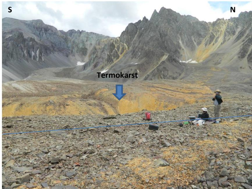
Figura 7.7. En la fotografía se observa la ubicación del perfil C de TRE en forma paralela al termokarst. La abundante presencia de material fino, de coloración amarillenta, favorece el buen acoplamiento de los electrodos. En el fondo de la imagen se puede observar las 2 raíces con sus claras diferencias litológicas.
