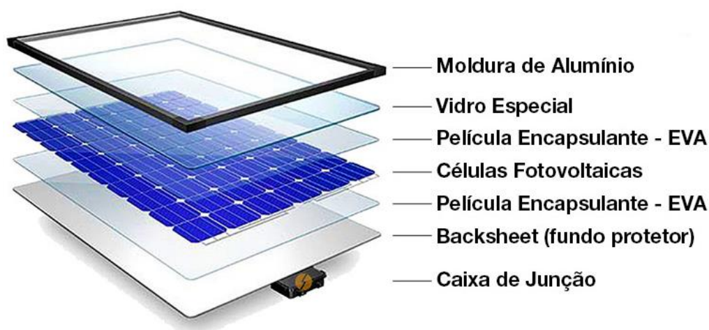
Figura 07 – Camadas construtivas de um módulo fotovoltaico
