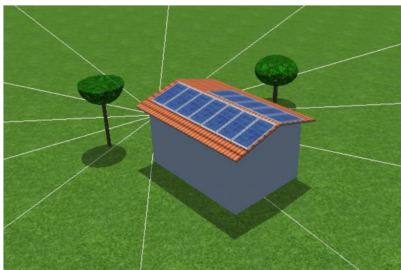
Figura 17 – Alocação dos módulos sobre o telhado
