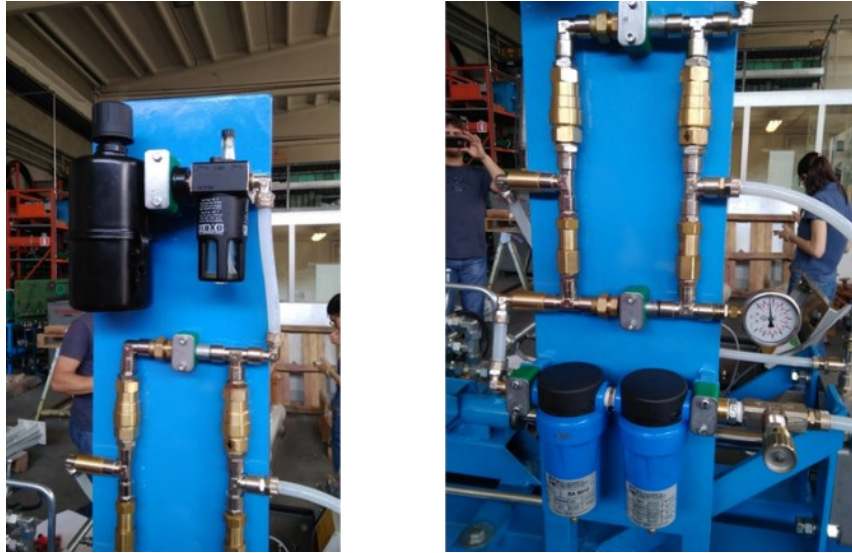
Figura 6.7 – Dettaglio del sistema di filtraggio in aspirazione (sx) e del blocco di linearizzazione flusso e sistema di filtraggio in mandata (dx)
