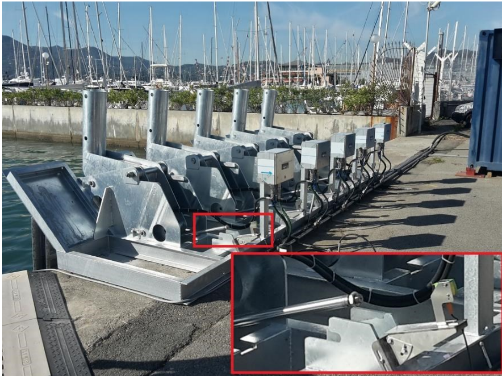
Figura 5.15 – Dettaglio sistema di lettura posizione
