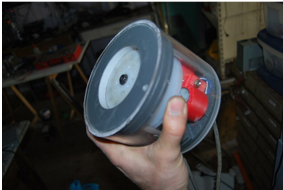
Figura 4.4 – Navicella centrale del modello di Seaspoon, senza pale
