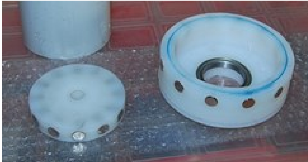
Figura 4.3 – Dettaglio del giunto magnetico
