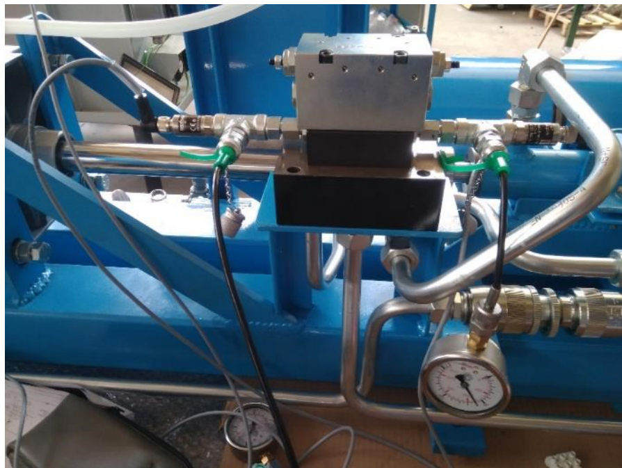
Figura 6.10 – Dettaglio della valvola oleodinamica di inversione
