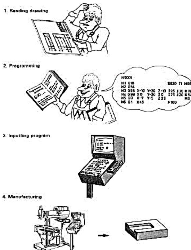
Gambar 2.1 Prinsip Kerja Mesin *CNC*
