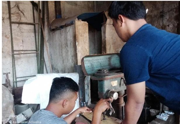
Gambar 4.25 Pembuatan Lubang Baut Bagian Bemper *CNC*
