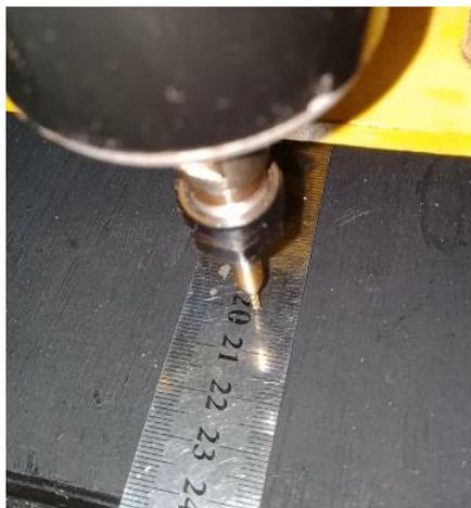
Gambar 4.55 Hasil Uji Gerak Langkah 200 mm
