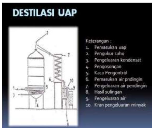
Gambar 4.14 Cara kerja alat destilasi uap
