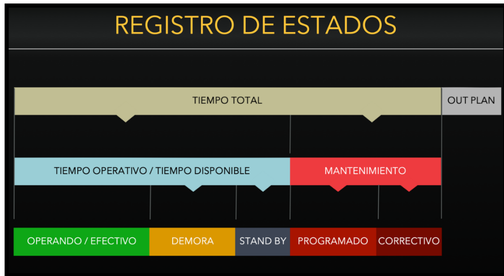
Figura 8. Estados de equipos en el ciclo de carga y acarreo.
