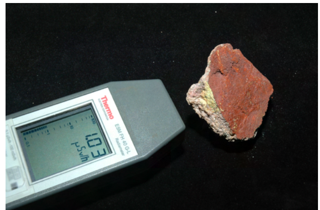
Figura 90. Radioactividad de una muestra de autunita (cristales amarillos) medida con la ayuda de un escintilómetro.
