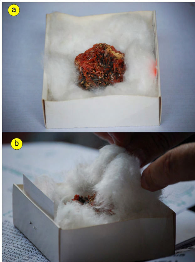
Figura 118. Envoltura de muestras muy delicadas con algodón. a) sentamiento de la pieza; b) recubrimiento previo al cierre de la caja. Crocoíta, Tasmania, Australia.
