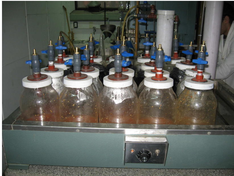
Imagen 2: Disposición de reactores en baño termostático.
