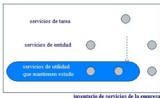
Figura 29: La gestión de información de estado se difiere a los servicios de utilidad, mejorando el escalamiento de los servicios de las capas superiores. Fuente propia
