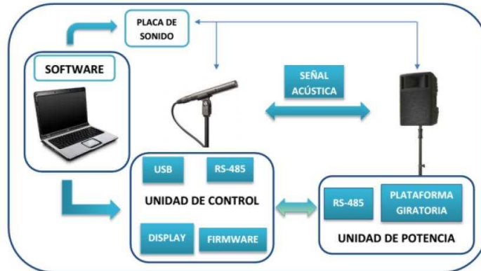
Figura 1: Diagrama de bloques del SAMDir v2.0.
