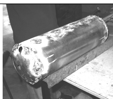
Figura 5: Proceso de soldado del tanque
