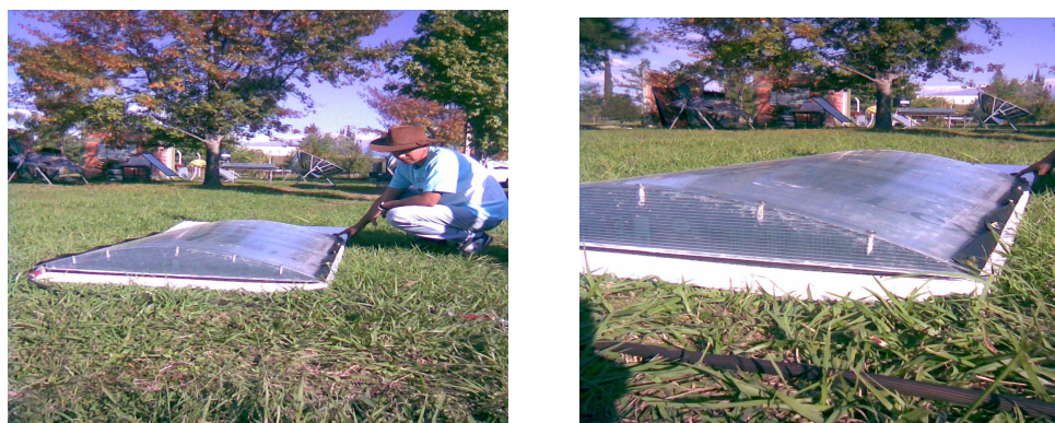
Figura 4: prototipo definitivo del colector con cubierta de policarbonato alveolar
