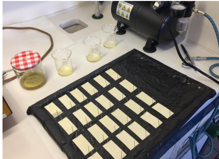
Figura 1. Aplicación mediante aerógrafo del barniz en las probetas.
