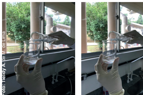
Figura 2. Dissolução de trietanolamina (TEA) em água.
