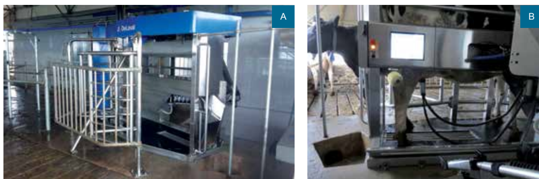
Figura 4. Unidade de sistema de ordenha automático instalado na Fazenda Morro dos Ventos, Carambeí, PR (A), e detalhe do braço robótico em operação durante a ordenha voluntária (B).
