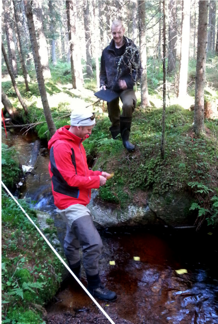
Pienten purojen rakenteellista tilaa voi seurata helposti tekemällä keinolehdillä uittokokeita. Suorassa ja rakenteellisesti yksinkertaisessa uomassa lehdet uivat nopeasti koalueen läpi, kun taas kunnostetussa purossa ne jäävät matkan varrelle.
