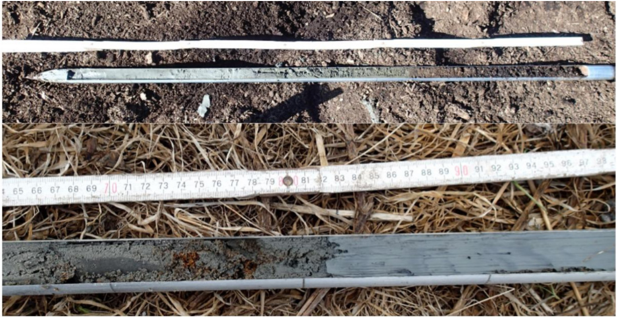
Kuva 32. Kaikilta tutkimusalueilta otettiin useampia maaperänäytteitä (ylempi kuva). Alakuvassa maaperäprofiilin oikea puoli: pelkistynyt hienorakeinen sulfidinen mineraalimaa (mineraalimaa vielä tiivis, joka ei juuri johda vettä). Alakuvassa profiilin vasen puoli: hapettunut karkearakeinen sulfidinen maa, johon on muodostunut rakennetta, eli halkeamia, joita pitkin vesi ja ilma pääsevät helposti kulkemaan. Hapettuneessa sulfaattimaassa on myös usein oranssinruskeita rautasaostumia (näkyvä myös kuvassa). Kuvat: Miriam Nystrand.
