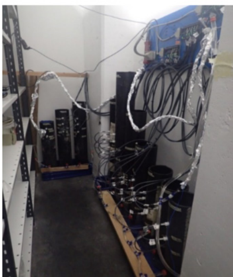
Kuva 34. Maaperän hapettumiskoe laboratorio-olosuhteissa (22 °C). Kokeessa tavoitteena oli simuloida kahden peräkkäisen äärimmäisen kuivan kesän vaikutusta ja tutkia eri paksuisen (0, 5, 15, 30 ja 50 cm) turvekerroksen suojaavaa vaikutusta alla olevan mineraalimaan hapettumiseen. Kuva: Miriam Nystrand.
