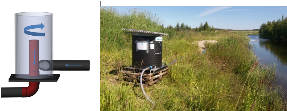
Kuva 52. Vasen: havainnekuva neutralointikaivosta. Kuva: Nordkalk Oy. Veden kulkusuunta sinisillä nuolilla. Oikea: Neutralointikaivo maastossa. Kuva: Mirkka Hadzic.
