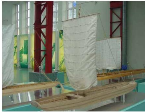
Fig. 27. A reconstruction of Woerden 7 , currently at the Museum für Antike Schifffahrt te Mainz . Note the tall, rectangular sail 595 .
