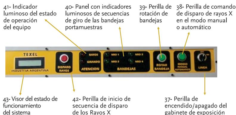
El *gabinete de exposición* (Fig. 3.18) en su interior posee un *dispositivo giratorio de arrastre horizontal* o *disco maestro* (47) que se mueve en el sentido de las agujas del reloj, un *controlador digital* por microprocesador (circuito electrónico en placa impresa) (44), un
