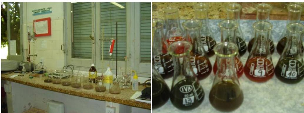
**Figura 8.** Procesamiento de muestras para determinación de carbono orgánico en laboratorio.
