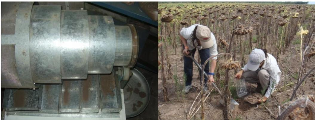
**Figura 10.** Tamiz rotativo (izq.) y toma de muestras inalteradas para determinar fracción erosionable por el viento (der.)
