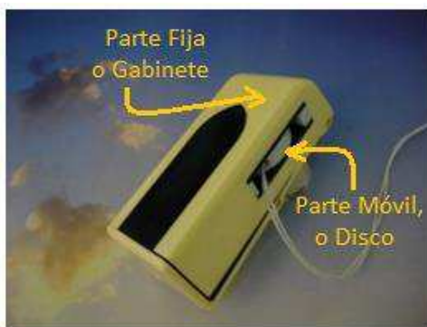
Figura 12. Prototipo del gabinete donde se indican las partes constitutivas
