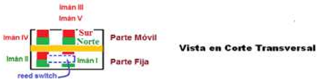
Figura 14. Esquema del dispositivo en Corte Transversal con detalle del Circuito Magnético
