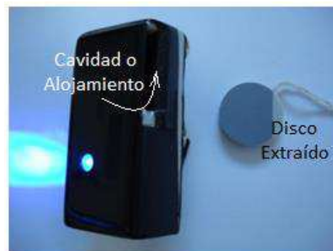
Figura 12. Prototipo del gabinete donde se indican las partes constitutivas
