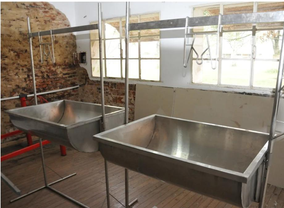
Último modelo de faenador, fabricado con estructura de acero inoxidable, explotando así las características del material haciendo de éste un producto más resistente al paso del tiempo. Sumado a esto es mucho más simple su limpieza y el uso del mismo.
