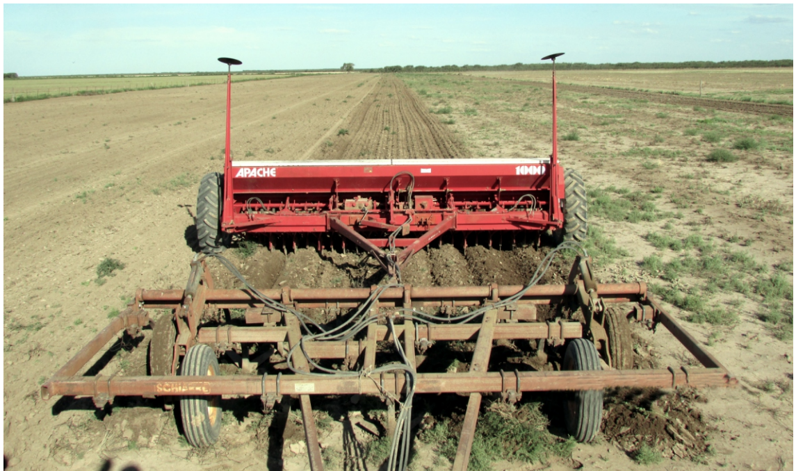
Foto 24: Equipo de siembra operando, se puede observar la eliminación total de las malezas (cardo ruso), las cuales quedan descalzadas en la superficie labrada del suelo donde se desecan rápidamente.
