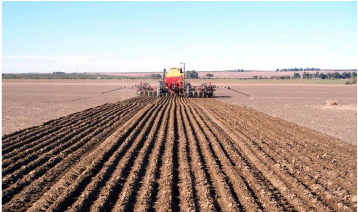
Foto 8: El sistema de siembra directa por arco está ampliamente adoptado en las Grandes Planicies Americanas. Este sistema permite solucionar los típicos problemas de la siembra directa y los de la labranza convencional (Servera, A. comunicación personal).
