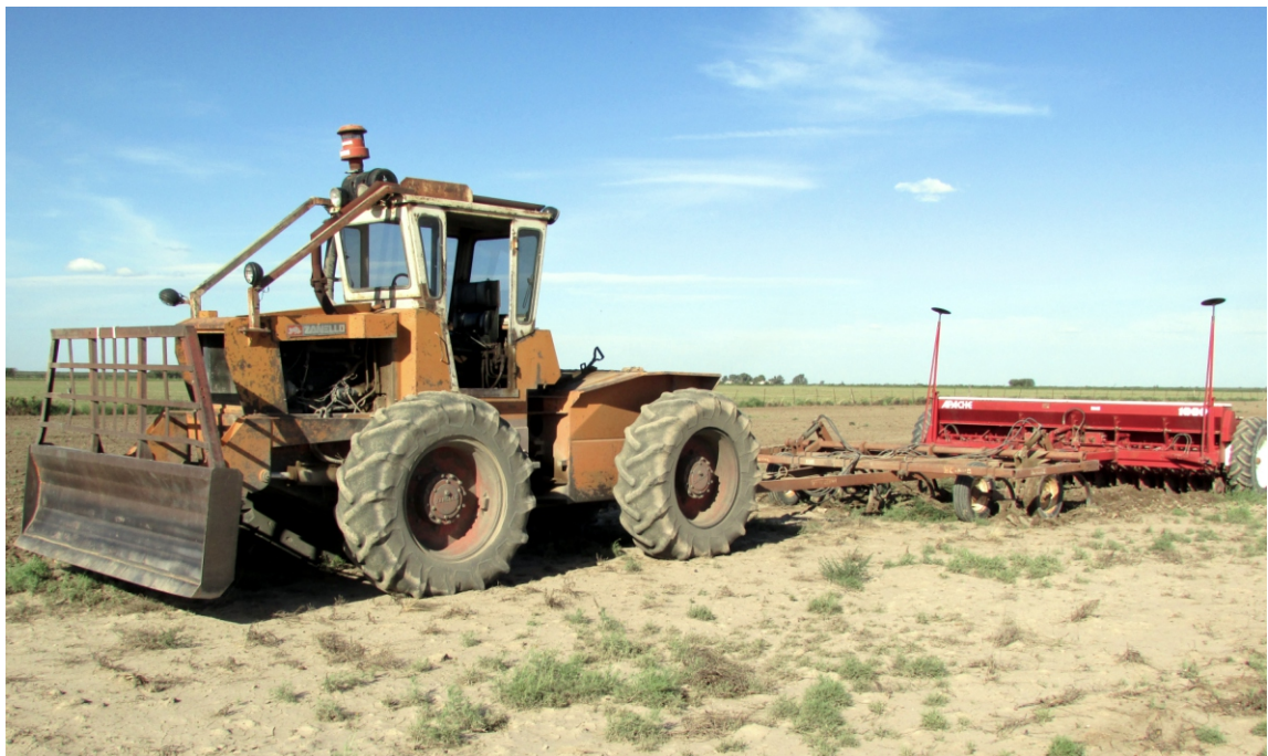
Foto 22: Equipo de siembra convencional utilizado en la región integrado por tractor, arado de cinceles y sembradora convencional de granos finos con doble disco y rueda compactadora.
