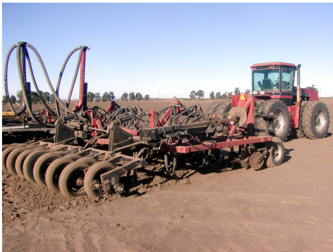
Foto 7: Sembradora Concord de siembra directa por arco que combina el efecto de remoción de una herramienta de labranza vertical como un cincel y los sistemas de siembra directa tradicionales (Servera, A. comunicación personal).
