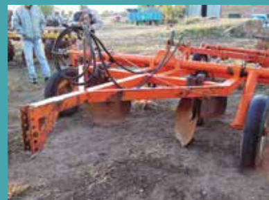
Figura 3.9. Tapadora de almácigo de discos. Foto Héctor Martí.
