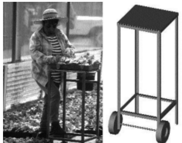
Figura 4. Mesa trasladable, de construcción sencilla, para levantar el plano de trabajo, por ejemplo durante el desmalezado de bandejas en viveros (Fuente: Baron, S. et al., 2002 ).
