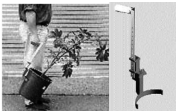
Figura 3. Implemento para el levantamiento de pesos sin doblar la espalda. (Fuente: Baron, S. et al., 2002).
