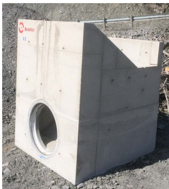
Bilde 15 over. Inntaksløsningens utsparing for stikkrennen. Den er laget med innstøpt gummipakning for tett overgang. Utformingen til grøfteprofilen, og bakveggenes forhøyning kommer også frem. (Foto: Morten Austdal)
