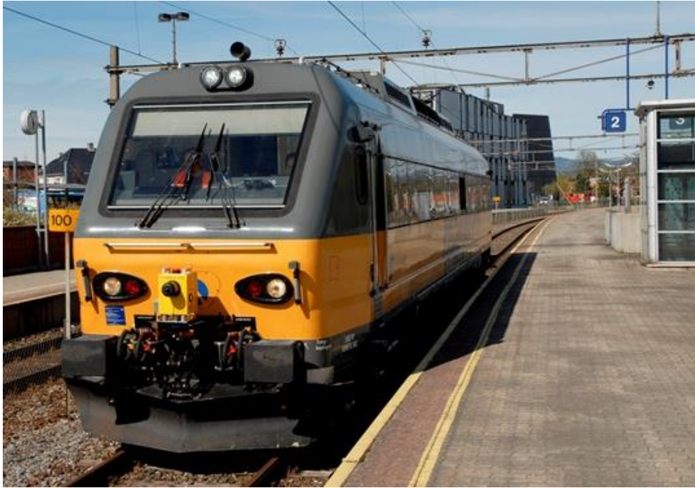
Figur 16 – Målevogn ROGER1000 Foto: Jernbaneverket 31
