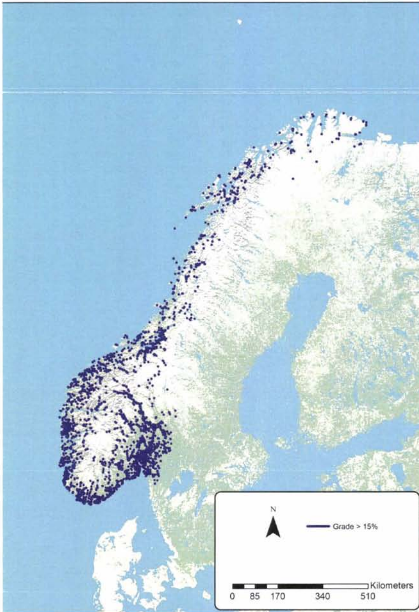
Figur 24 Veglenker med over 15 % stigninger og fall
