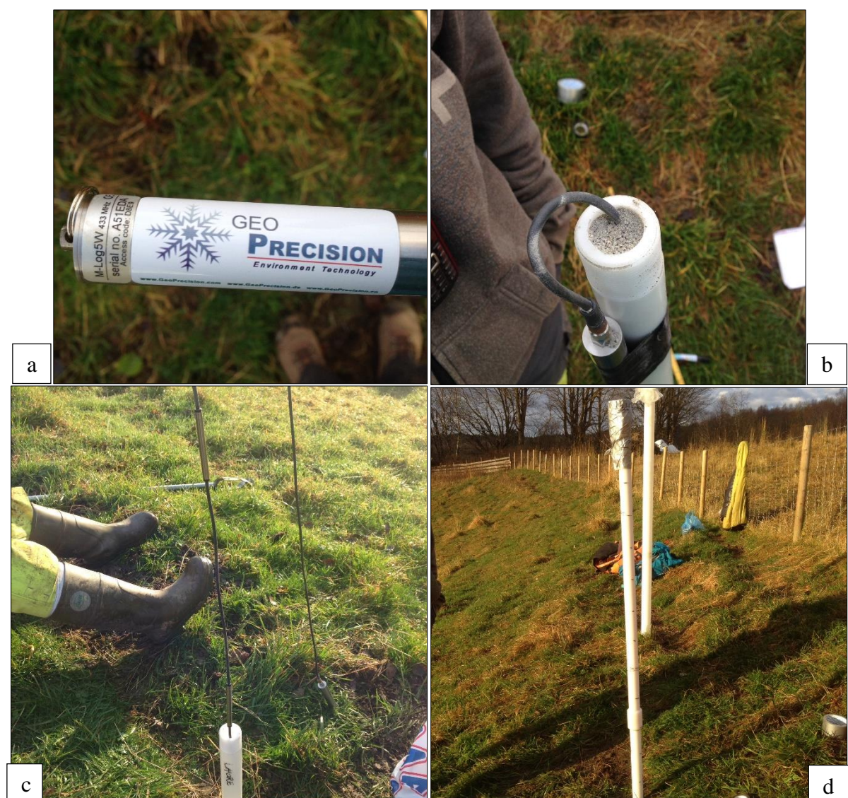
Figur 4.6 Nedsetting av temperaturmåleren, a) modell og leverandør av utstyret, b) temperaturmåleren er satt ned i røret og fylt igjen med sand for å forhindre konveksjon av luft i røret, c) ledningen med de to øverste temperaturmålerne før de blir senket ned i røret og d) temperaturmåleren ferdig montert med toppen godt forseglet. Foto: Hilde D. Jordet, 03.11.15
