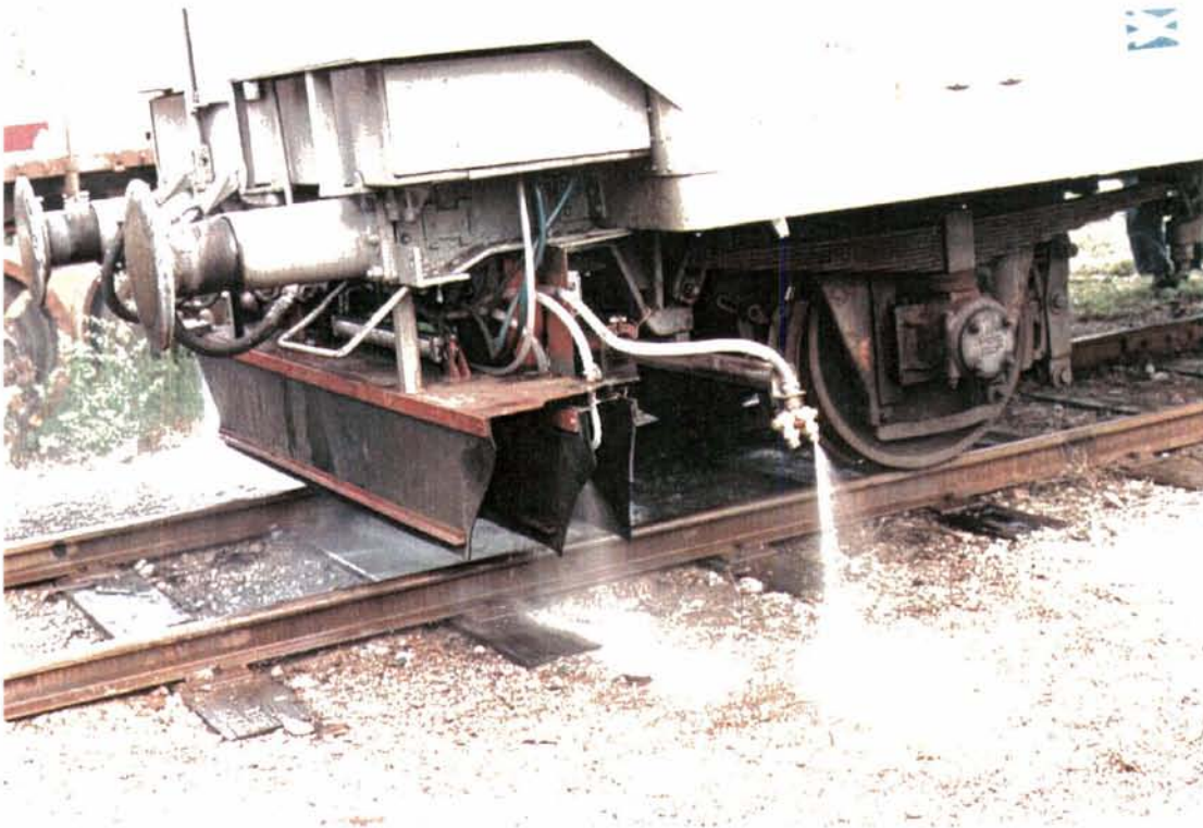
Figur 4. Gammelt svensk utstyr som Jernbaneverket leide inn. Bildet under viser bom og endedyse.
