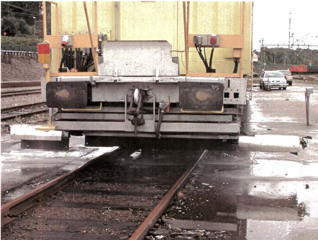
Fig. 5. Nytt svensk sprøytetog. Nederste bilde viser bom med endedyse som vi ser stikker utenfor luftskjermen.
