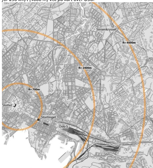
Figur 7.3: Krav til minste horisontalradie for motorvei (700 m), jernbane dimensjonert for 200 km/t (2400 m) og jernbane dimensjonert for 250 km/t (4000 m) vist på kart over Oslo.
