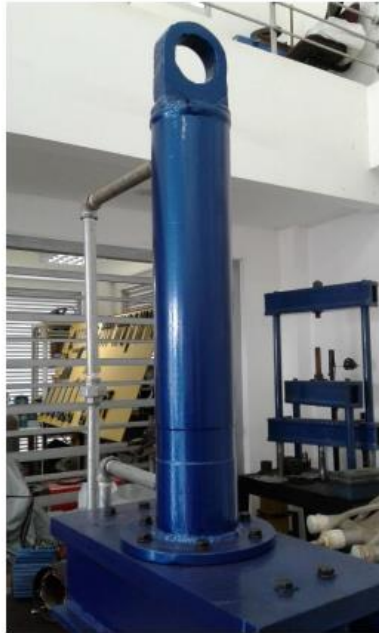
Figura 15. Cilindro hidráulico doble efecto validado
