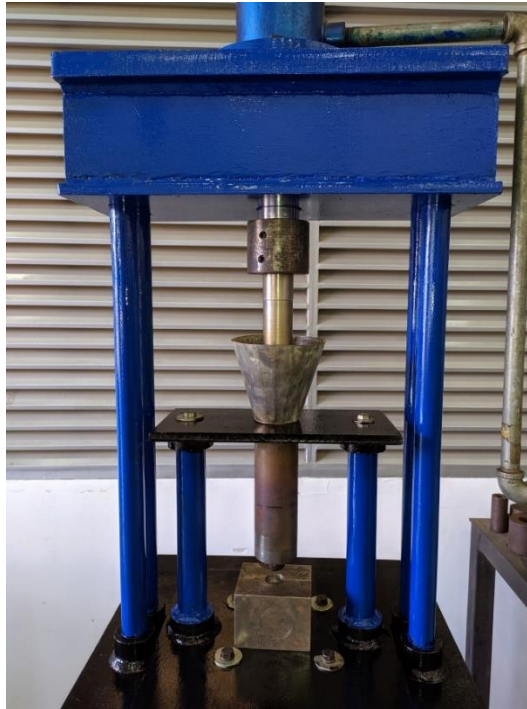
Figura 38. Máquina de inyección para polipropileno parcial.
