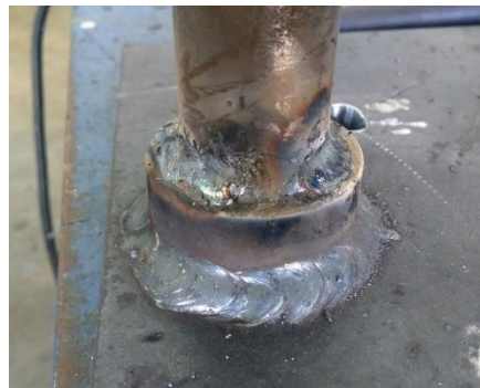
Figura 32. Soldadura de columnas secundarias en los bujes.
