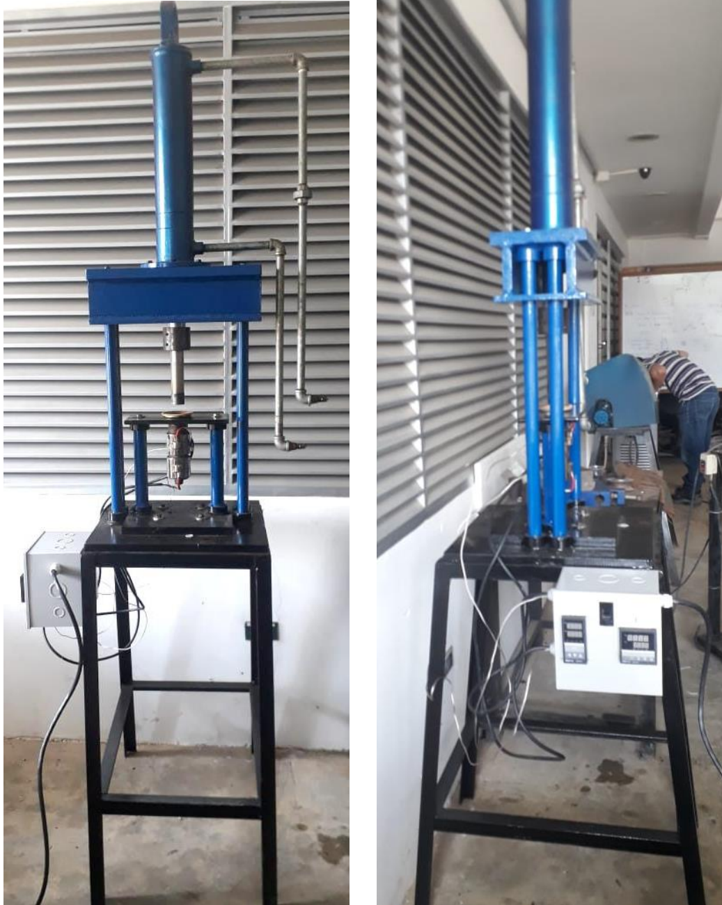
Figura 41. Máquina inyectora para polipropileno tipo vertical terminada.
