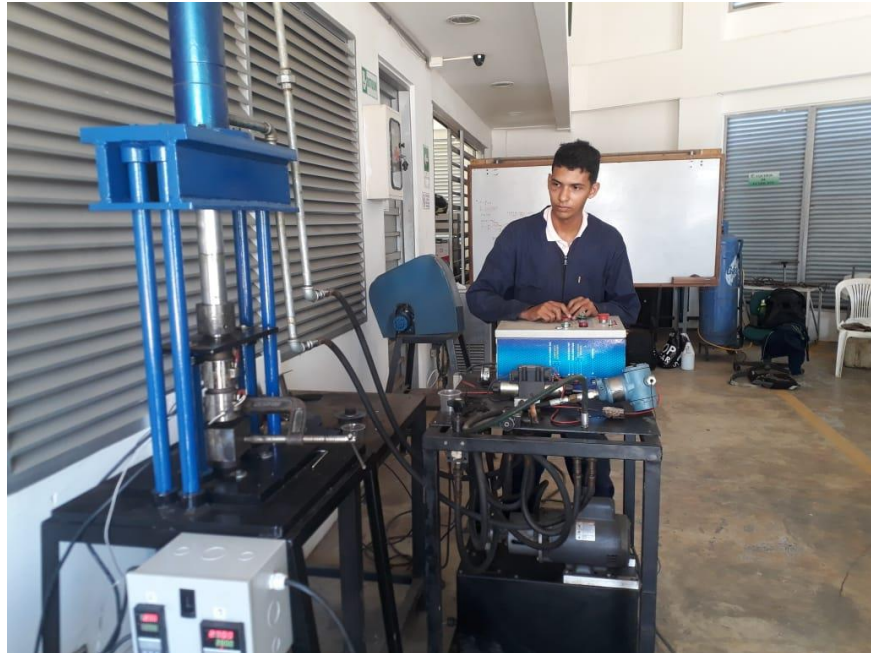
Figura 56. Accionamiento del avance del torpedo de inyección.
