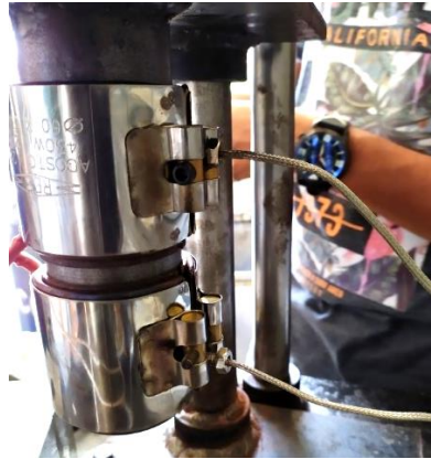
Figura 39. Resistencias eléctricas y termocuplas tipo j ubicadas en el cilindro de plastificación.
