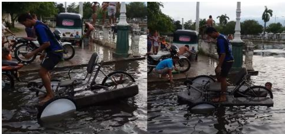
Figura 74. Prueba de estabilidad del vehículo en agua.
