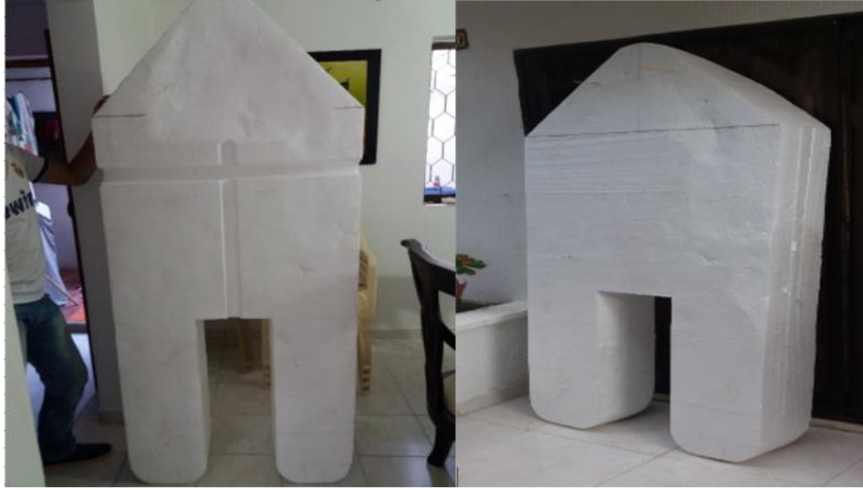
Figura 48. Molde final del casco en poliestireno expandido.
