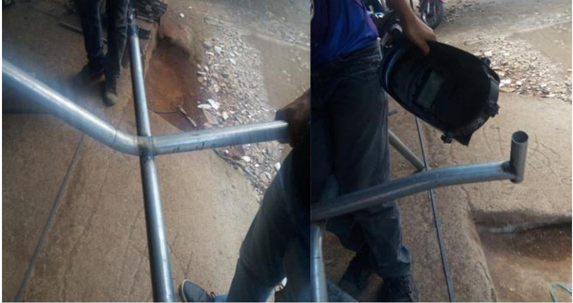
Figura 58. Proceso de unión por soldadura del tren delantero con el tubo central.
