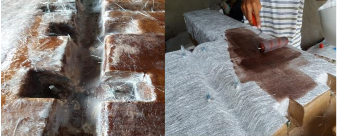
Figura 51. Proceso de impregnación de la fibra de vidrio con resina de poliéster.
