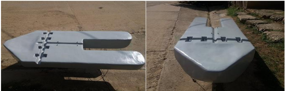
Figura 56. Casco del VTH completamente terminado y pintado.
