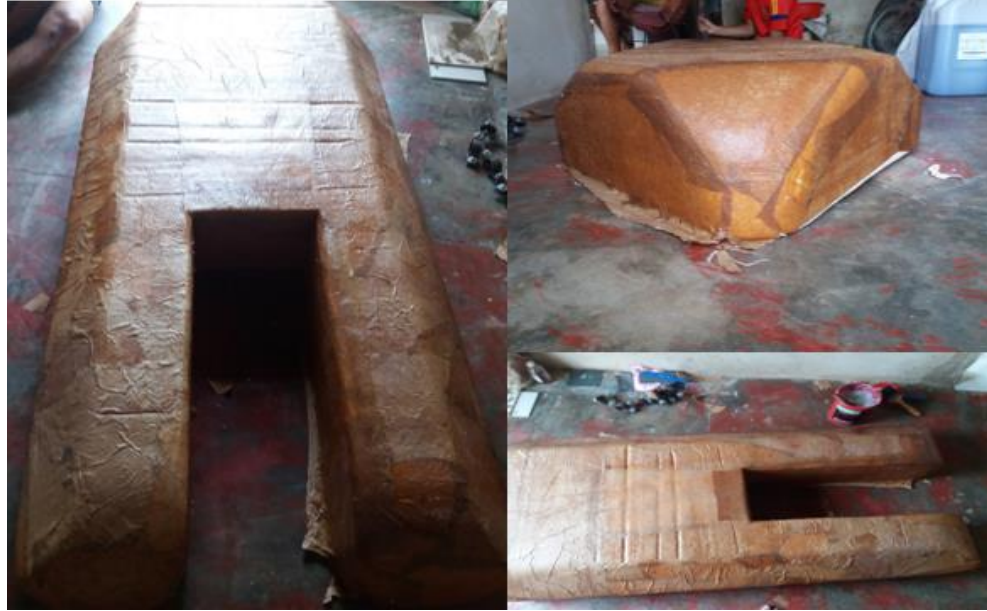
Figura 49. Recubrimiento del molde de poliestireno expandido con papel Kraft.
