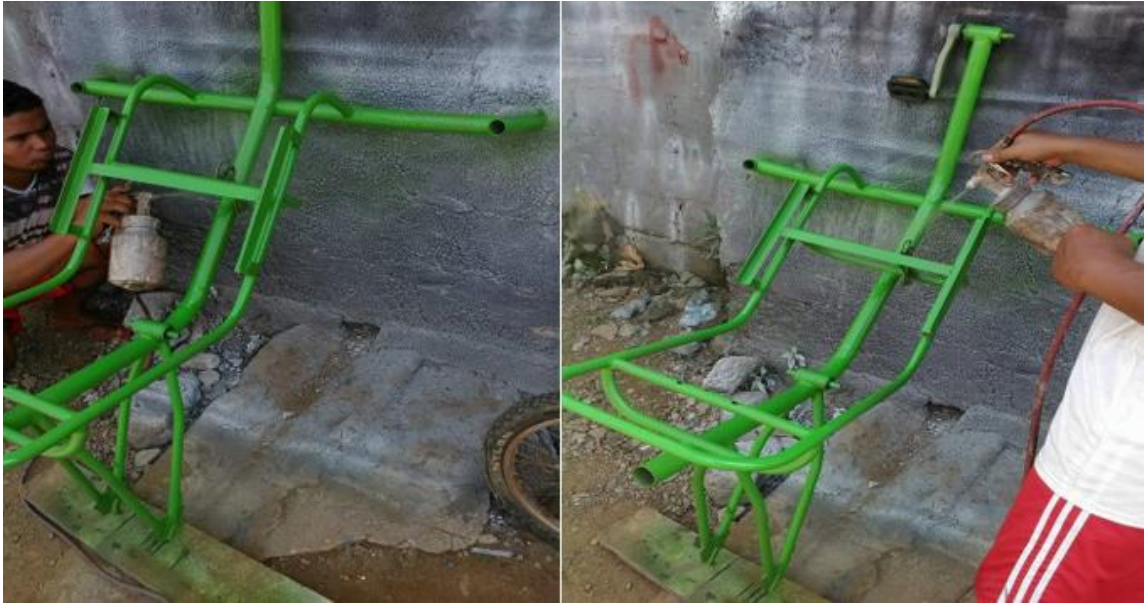
Figura 63. Proceso de pintado del chasis.
