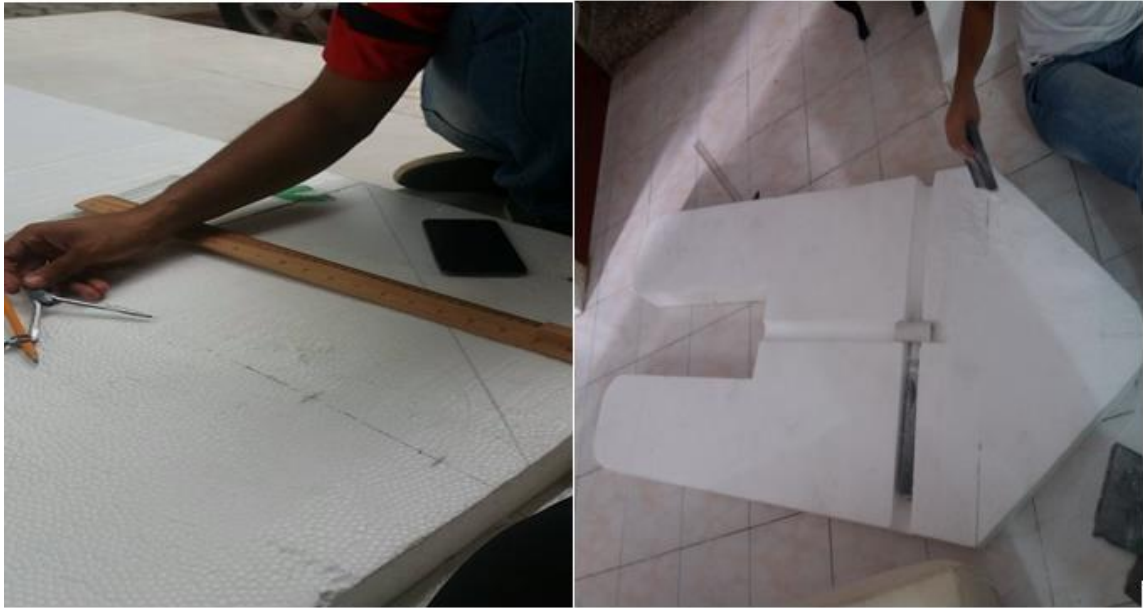
Figura 47. Elaboración de la geometría del casco en poliestireno expandido.
