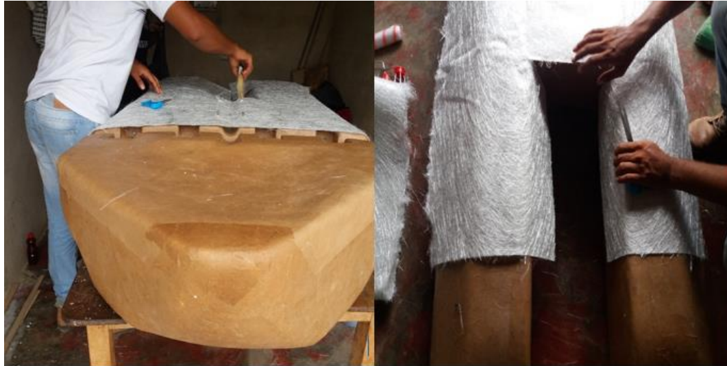
Figura 50. Medición y corte de las capas de fibra de vidrio MAT 450.
