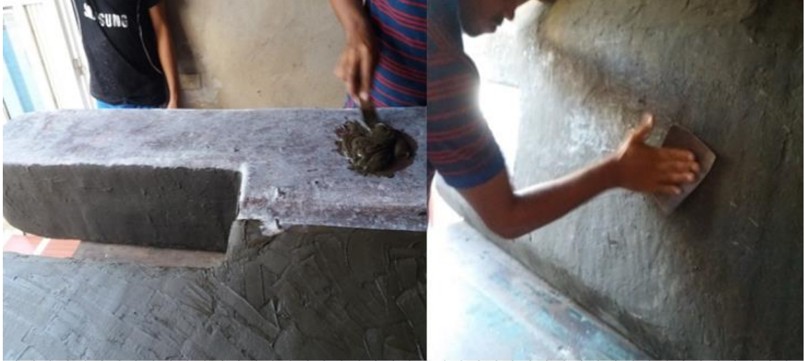
Figura 55. Recubrimiento del casco con masilla y pulido del casco.
