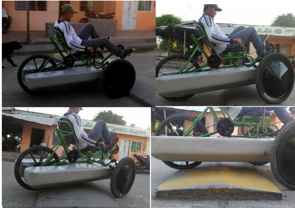
Figura 79. Prueba de impacto contra resalto.
