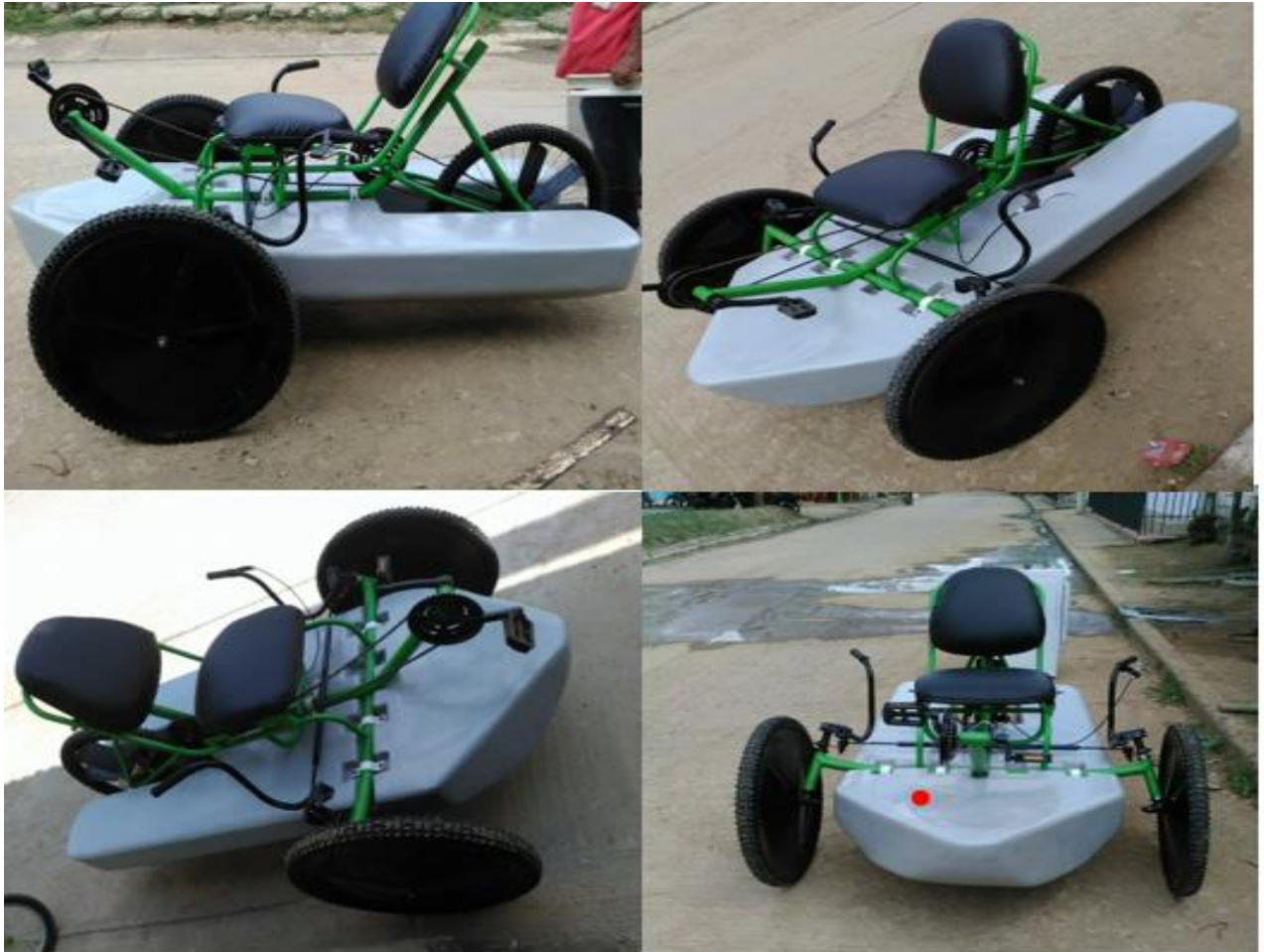
Figura 66. VTH anfibio completamente ensamblado.
