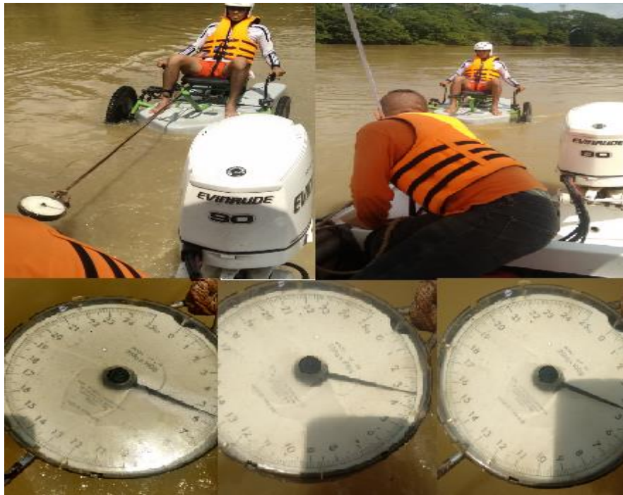
Figura 83. Validación de fuerza de arrastre.
