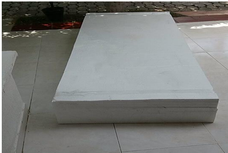
Figura 46. Bloque de poliestireno expandido utilizado para la construcción del molde del casco.
