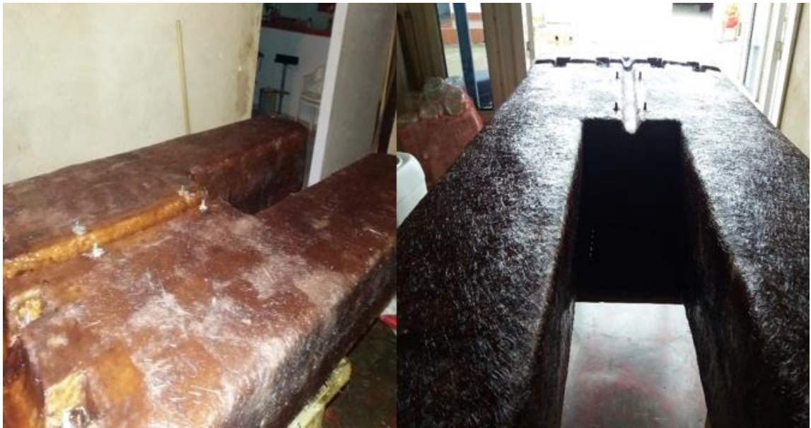
Figura 53. Recubrimiento finalizado del casco con fibra de vidrio.
