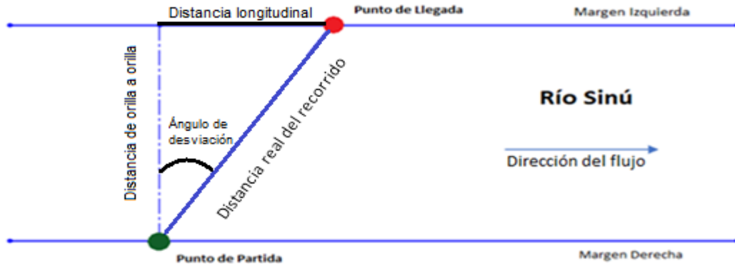
Figura 24. Esquema de prueba de desplazamiento transversal en el río Sinú.
