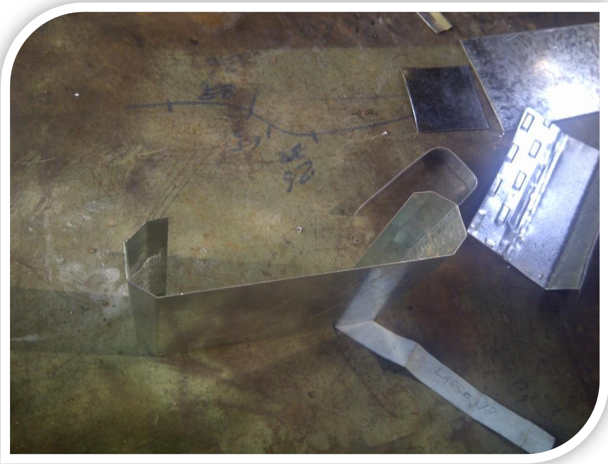
Ilustración 19. Doblado del chasis
