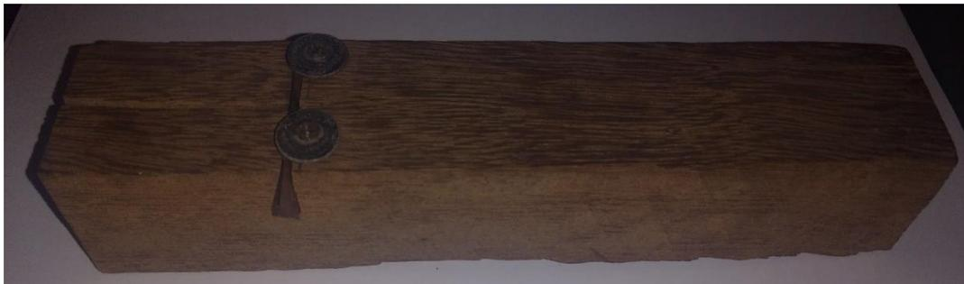
Figura 4.2: Dispositivo de corte de fabricación propia para obtención de fibras de PET y PP.
