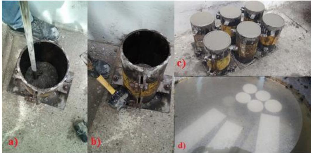
Figura 5.16: Proceso de fabricación de las probetas para ensayos de compresión. a) llenado de moldes y apisonado con varilla de acero b) golpes laterales con martillo de goma para la liberación de aire atrapado en la mezcla c) enrasado y fraguado d) proceso de curado en agua.
