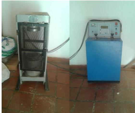
Figura 4.11: Máquina PINZUAR modelo PC 42 utilizada para los ensayos de compresión a las probetas de concreto reforzado con fibras de PET y PP.
