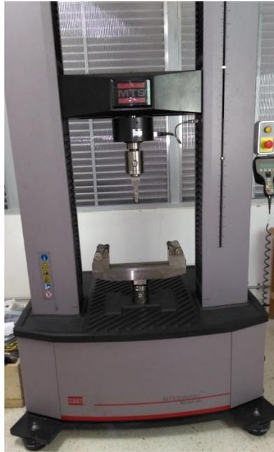
Figura 4.12: Máquina de ensayo universal marca MTS Criterion modelo 45, con capacidad máxima de carga de 300 kN.
