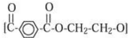
Figura 3.1: Estructura molecular del Tereftalato de Polietileno (PET).
