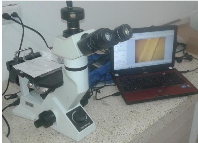
Figura 4.7: Microscopio marca OLYMPUS GX 41, dotado con una cámara digital OMAX de 9 megapíxeles y con software de adquisición de imagen TOPVIEW V3,7.
