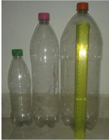
Figura 4.1: Botellas en diferentes presentaciones utilizadas para la obtención de las fibras de PET.
