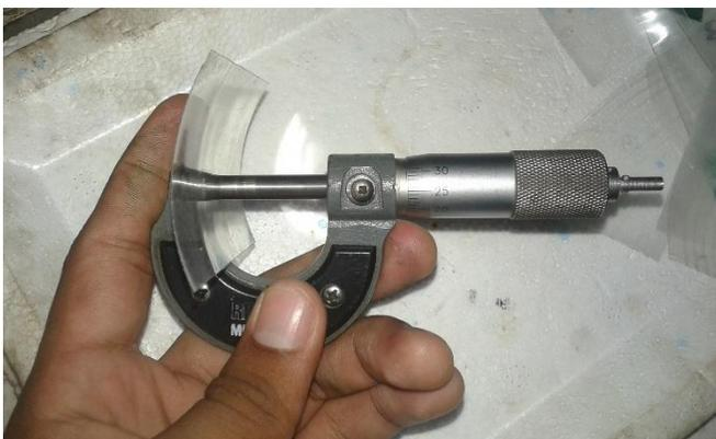
Figura 4.4: Micrómetro marca Mitutoyo con resolución de 0.001 mm y un rango de 0 – 25.4 mm utilizado para determinar el espesor de las muestras de PET y PP.
