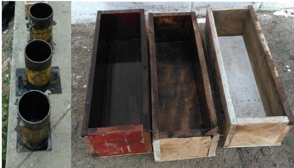
Figura 4.10: Moldes cilíndricos y prismáticos bajo la norma ASTM C31(2008) usados para la realización de las probetas de compresión y flexión.
