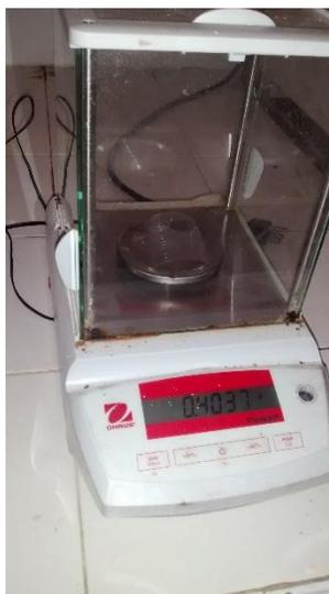
Figura 4.6: Balanza OHAUS-Pioneer, con capacidad máxima de 210 g y resolución de 0.0001 g empleada para determinar la masa de las muestras de PET y PP.
