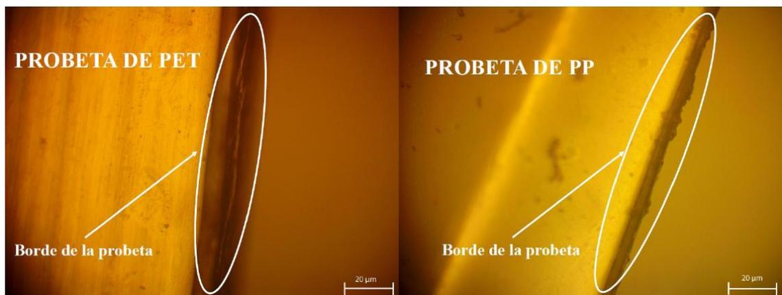
Figura 5.10: Bordes de las probetas de PET y PP vistos con un aumento de 50X a través del microscopio.
