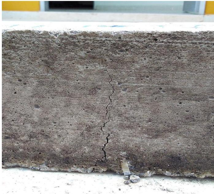
Figura 5.34: Probeta con adición de fibras de PET retirada de la máquina posterior al ensayo de flexión a tres puntos.
