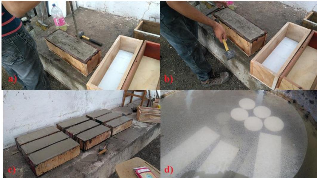
Figura 5.17: Proceso de fabricación de probetas para ensayos de flexión. a) llenado de moldes y apisonado con varilla de acero b) golpes laterales con martillo de goma para la liberación de aire atrapado en la mezcla c) enrasado y fraguado d) proceso de curado en agua.
