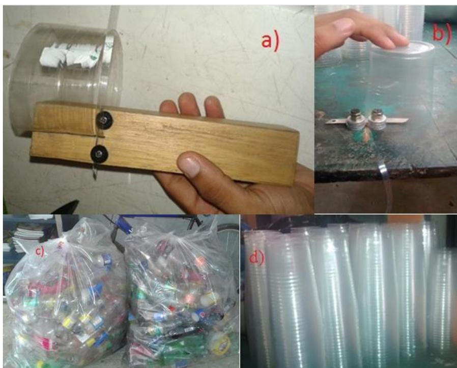
Figura 5.1: a) Dispositivo de corte empleado para la obtención de las fibras de PET. b) Herramienta de corte empleada para la obtención de fibras de PP. c) Botellas de PET empleadas para la obtención de las fibras. d) Vasos desechables de PP usados para la obtención de las fibras de PP.
