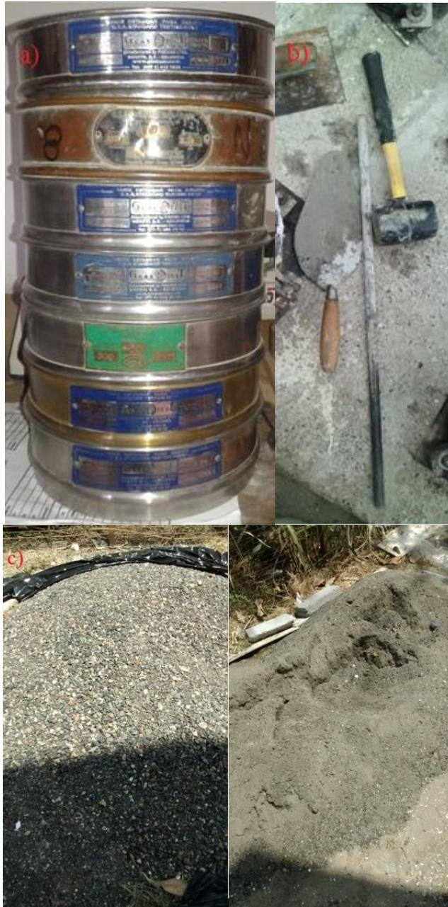
Figura 4.9: a) Tamices bajo la Norma ASTM D136 con los que se realizó la granulometría de los agregados. b) Herramientas (palaustre, martillo de goma, y varilla de acero) utilizadas durante el desarrollo del proyecto. c) Agregados grueso y fino utilizados para la preparación de concreto.
