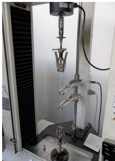
Figura 4.8: Máquina universal de ensayos marca Shimadzu de 5 kN utilizada para ensayos de tensión en las fibras de PET y PP.
