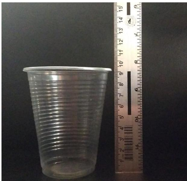
Figura 4.3: Vaso desechable de 9 onzas utilizado para la obtención de fibras del PP.
