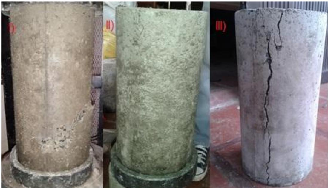
Figura 5.27: Tipos de fallas presentados en las probetas de concreto durante los ensayos de compresión. I) Falla tipo 5 presentada en las probetas de control. II) Falla no referenciada en la norma ASTM C39/C39M (2014) presentada en probeta de concreto con 1.5 % de fibra de PET. III) Falla tipo 3 presentada en probeta de concreto con 2.0 % de fibra de PP
