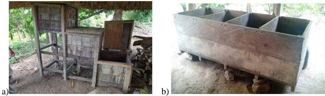
Figura 8. Tipo de fermentador utilizado en las zonas de estudio. a. Escalera en Alto Sinú; b. Lineal en Montes de María.
