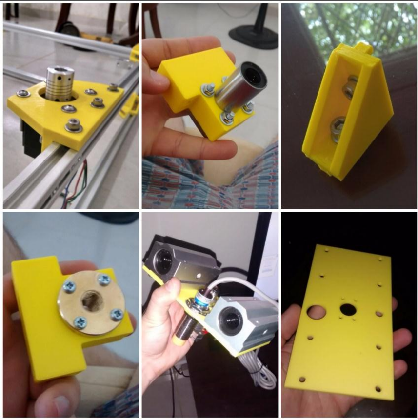
Figura 48. Piezas fabricadas en PLA por impresión 3D. Fuente: Autor, 2017
