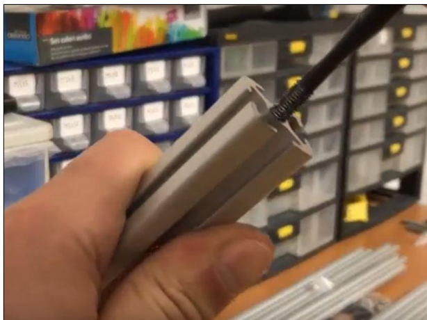
Figura 59. Proceso de roscado de los perfiles del chasis. Fuente: Autor, 2017
