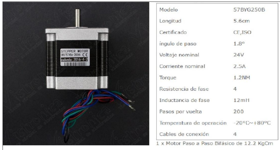
Figura 32. Ficha técnica motor paso a paso para los tornillos de potencia. Fuente: Autor, 2017
