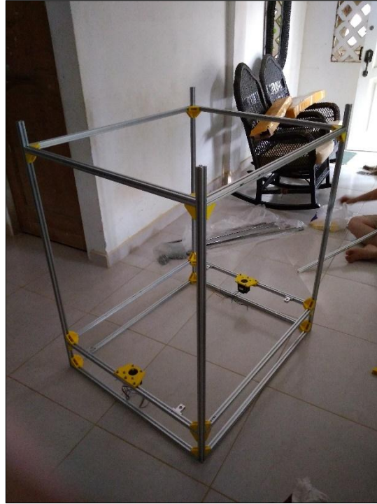
Figura 62. Montaje de refuerzos de chasis y soporte de motores eje "Z". Fuente: Autor, 2017
