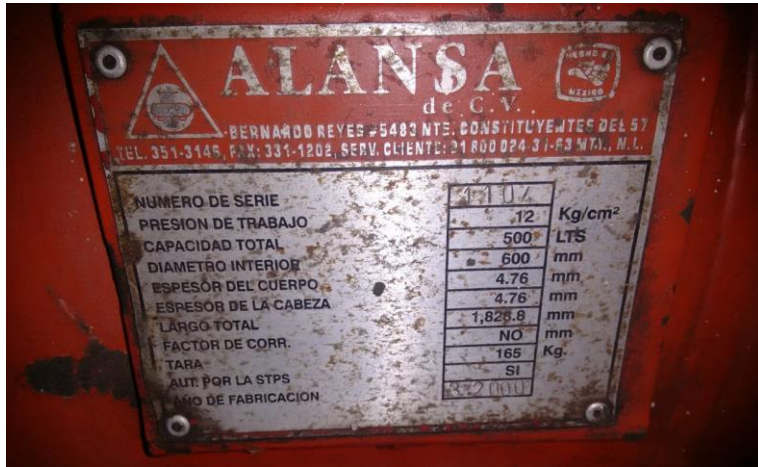
Figura 20. Ficha técnica del acumulador de aire. Fuente (Registro fotográfico, 2019)
