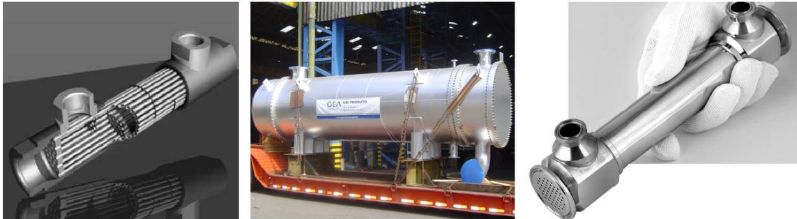
Figura 2. Intercambiadores de calor de tubo y coraza en la industria.
