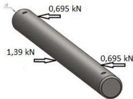
**Figura 51.** Diagrama de cuerpo libre del pasador del pie de apoyo.
