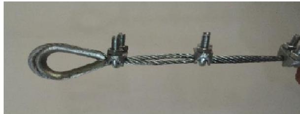
Configuración de los extremos del cable
