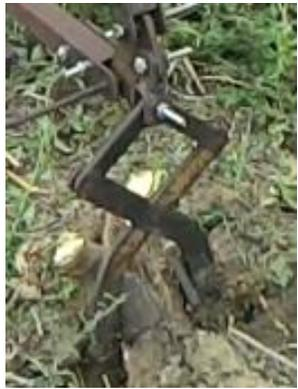
**Figura 103.** Montaje de la pinza sujetando el tallo de la yuca.
