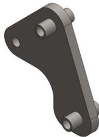
**Figura 80.** Placa de unión.
