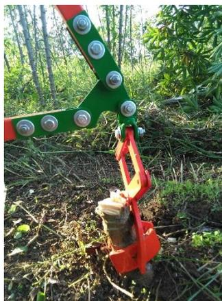
**Figura 114.** Montaje de la pinza sujetando el tallo en la zona 4.
