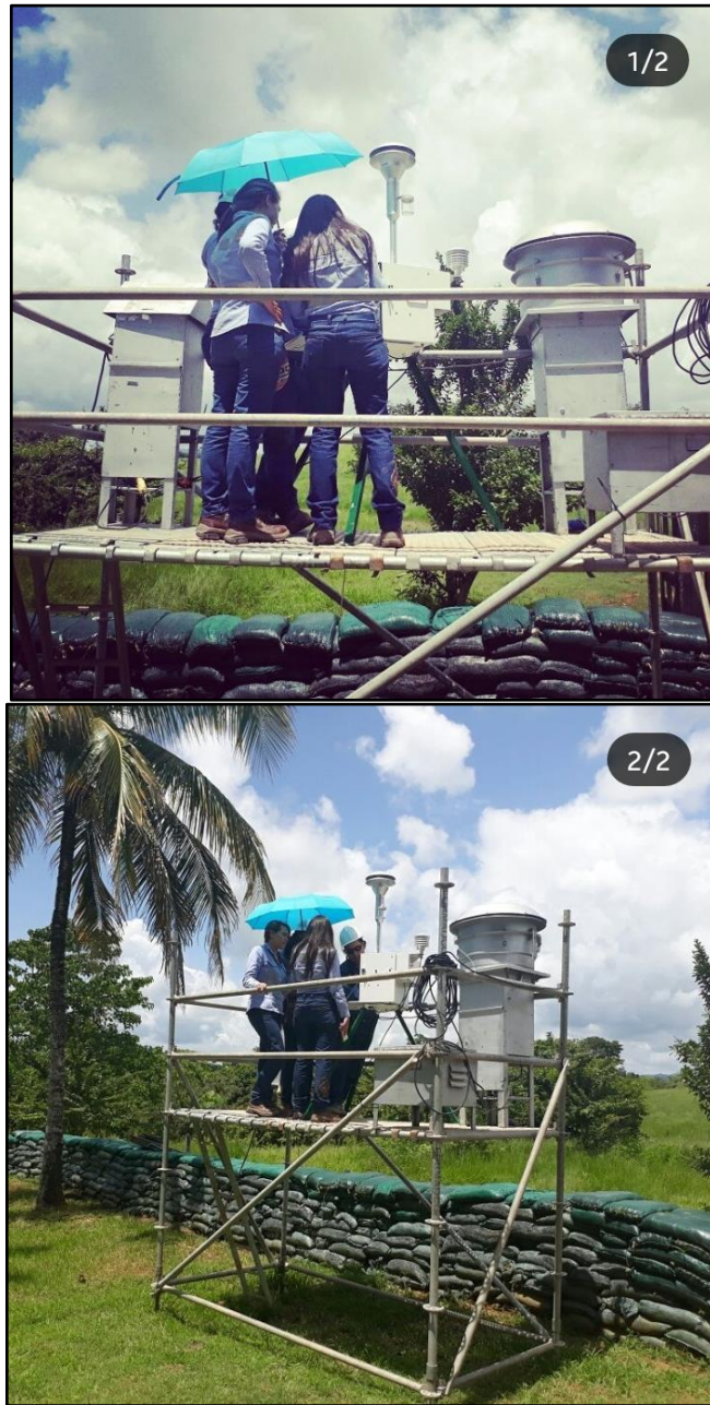
Ilustración 1. Verificación de coordenadas e inspección de equipos de estaciones de monitoreo de calidad del aire en el AID del Proyecto Minero Las Palmeras.
